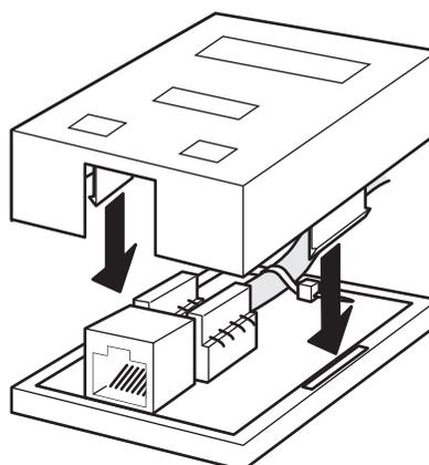
両側面のツメ位置を合わせてカバーを被せます。カチッと音がすれば完成です。
