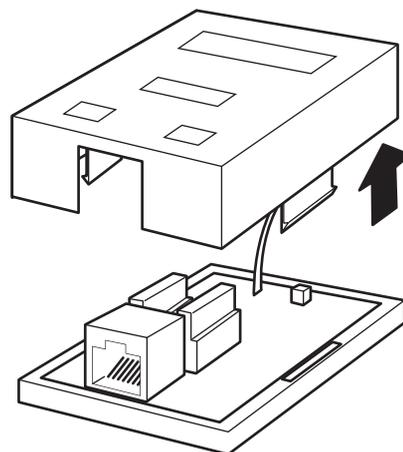
カバー両側面のツメが外れたら上へ持ち上げます。
