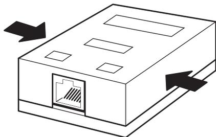
両側面（矢印の部分）を少し強めに押してカバーを外します。
